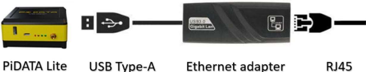
После подключения адаптера PiDATA Lite автоматически определит его и начнет использовать для подключения к сети. Дополнительная настройка не требуется.
